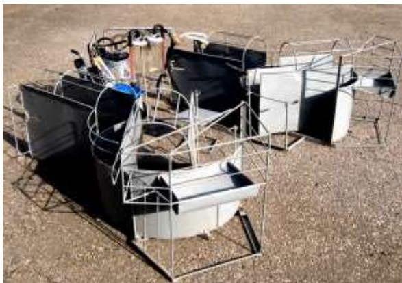
Рис. 1. Двохстанкова доїльна установка «Асканія-2» з використанням компонентів виробництва «Мілклайн»
