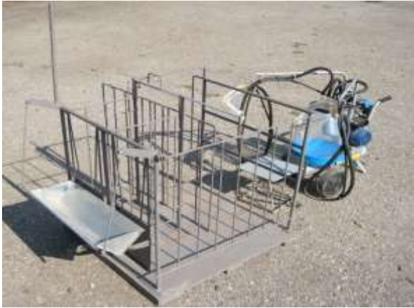
Рис. 2. Двохстанкова установка лінійного типу для доїння овець з компонентами «Мілклайн»
